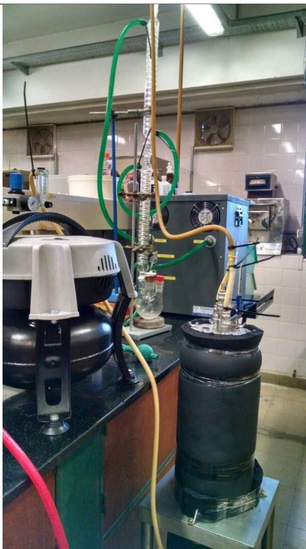
Figura 1: Sistema integral de separación mediante gas stripping.
